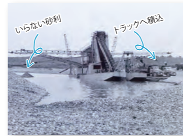
作業中の砂利採取船。天竜川にて。
